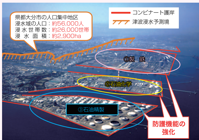
津波浸水予想と防護のために必要な護岸
