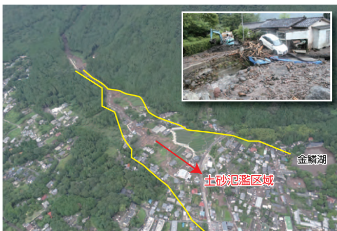
集落の上流約1.5kmで土石流が発生 H24 梅雨前線豪雨 岳本川(由布市)
