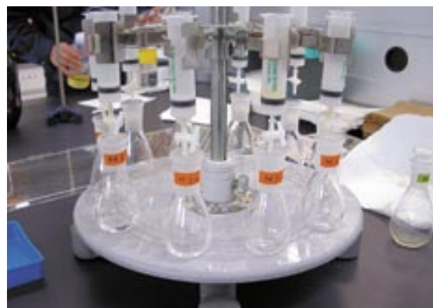
図1 抽出した残留農薬を含む試験液を精製する工程
