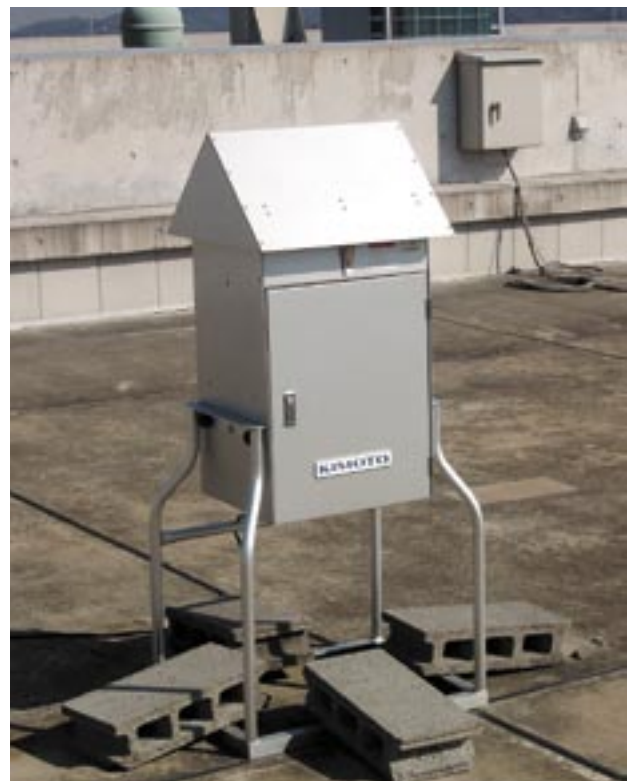
図1 ハイボリュームエアサンプラー (空気中の粉じんを採取する装置)
