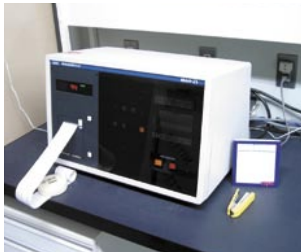
図3 環境放射線モニタ (空間放射線量率を記録する装置)
