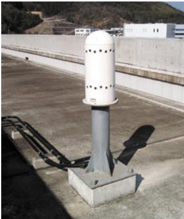
図2 モニタリングポスト (空間放射線量率を測定する装置)
