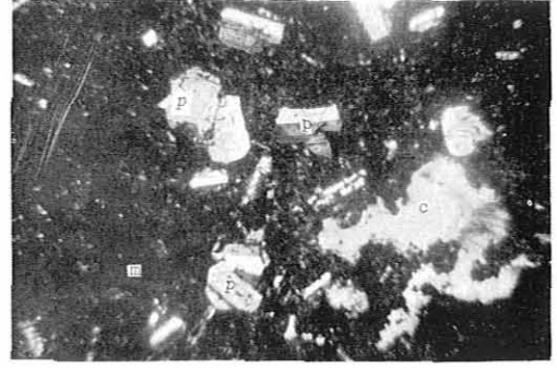
P、別府大学付近の岩芯 (-170m) (Quartz-calcite bearing, Hornblende Andesite) (+) nicol..... ×14
