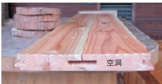
写真-1 吸音式内装材断面写真
