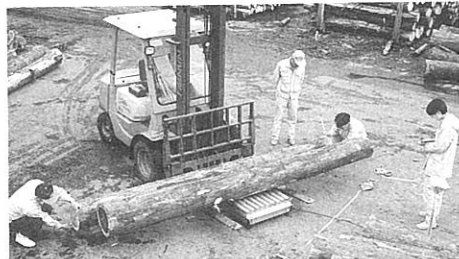
原木丸太のヤング率の測定
