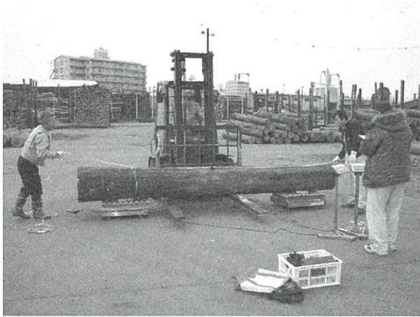
写真1 大径材の動的ヤング係数の測定
