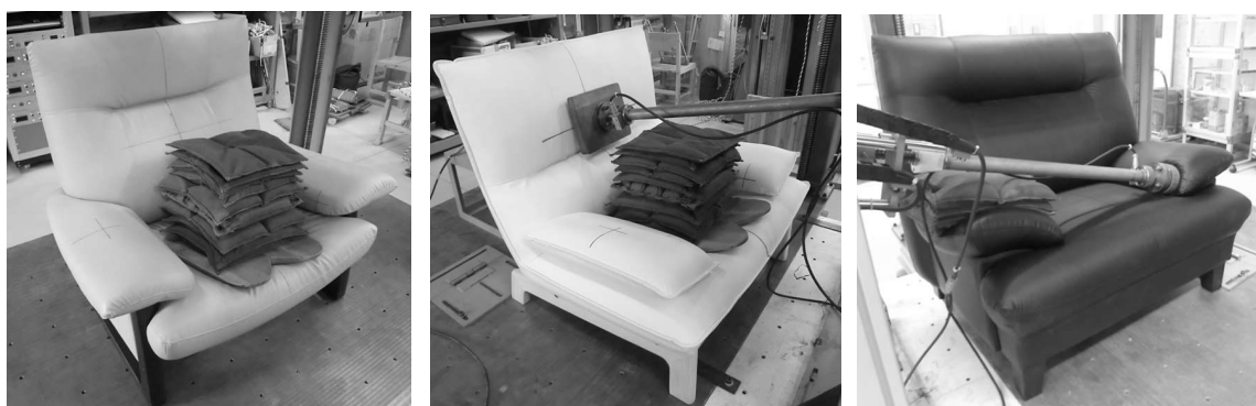
写真-4 ソファの強度試験 (左:座、中央:背、右:肘)
