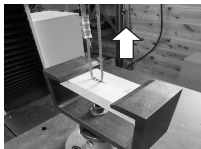
写真-2 引き抜き試験
