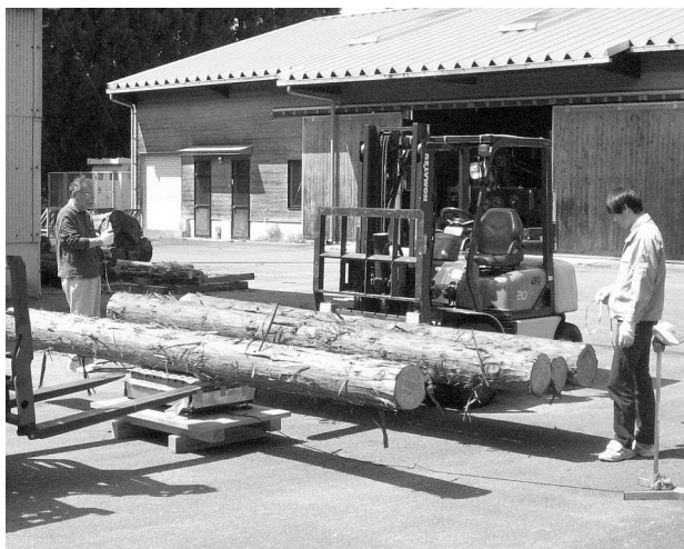
写真-1 丸太の動的ヤング係数の測定
