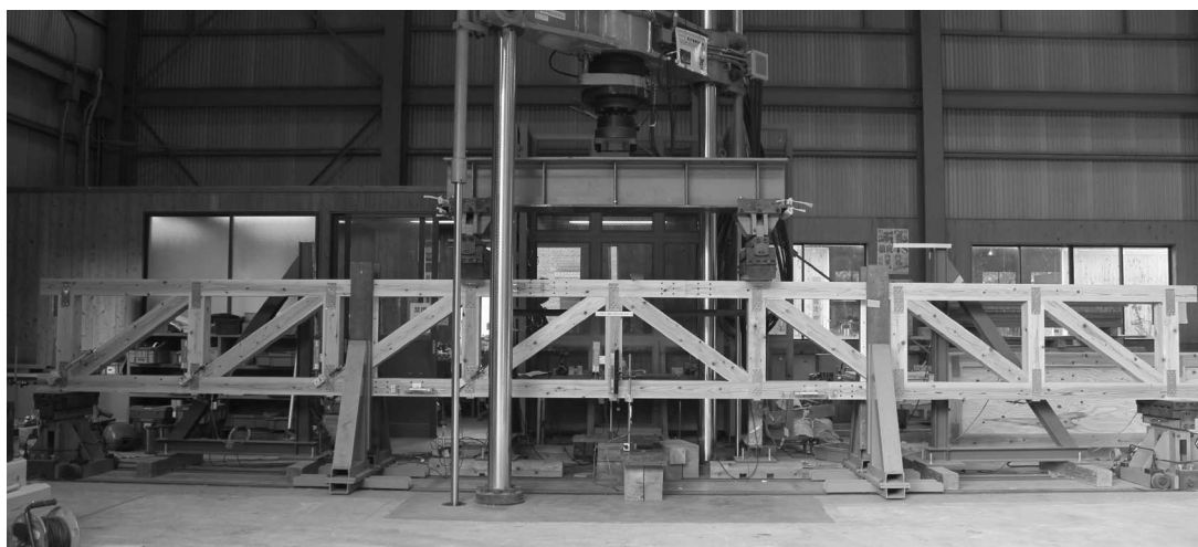
写真-2 組立梁の実大試験状況（トラスタイプA）
