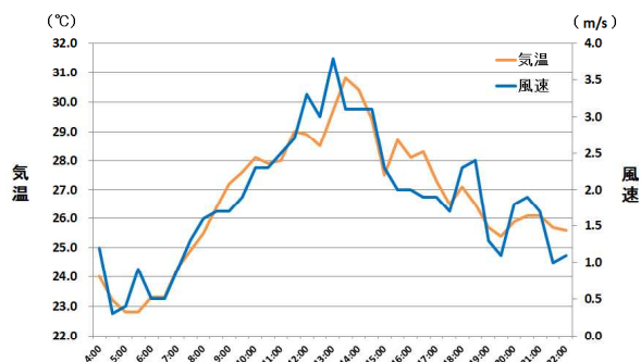
図5 気温と連動したファンの風速(調査日:平成27年8月6日)
