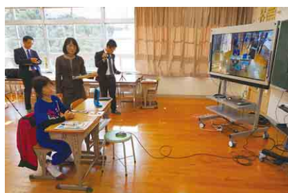
▲大型ディスプレイへの光の映り込みを軽減するために取り付けした遮光カーテン
