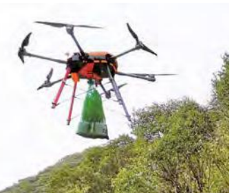
ドローンを活用した資材運搬
