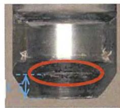
図 2 接手外面テーパ部の接触痕
