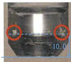
図 4 接手外面円筒部の局所的接触痕
