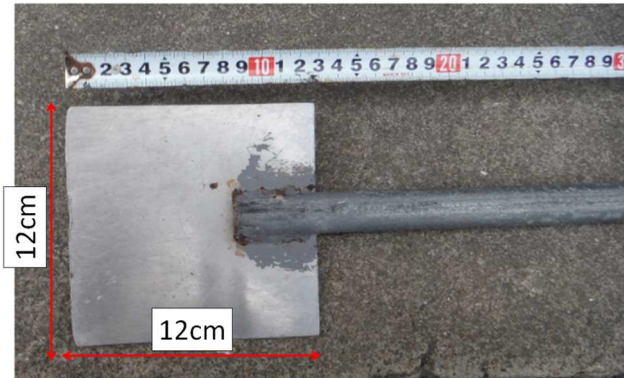
図Ⅲ-3(b) 自作したスクレイパー（先端部）
