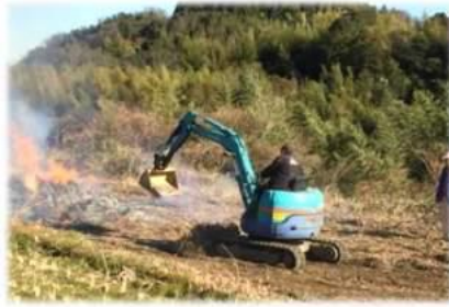
⇒ 根を重機で掘り出す
