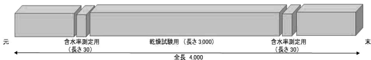
図-3 乾燥試験体(心去り材)の採取方法模式図(単位:mm)
