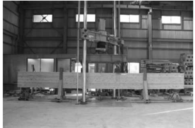
写真-4 曲げ試験の様子
