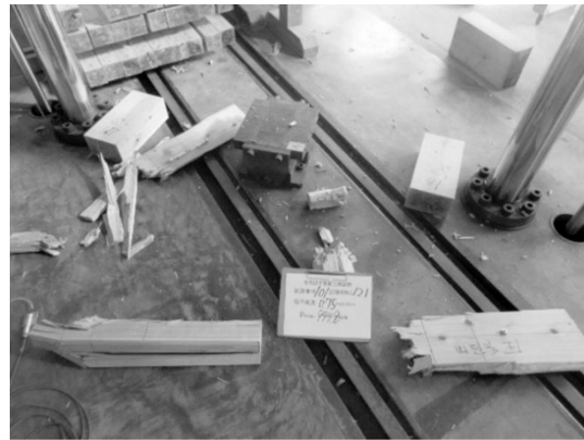
写真-4 割裂して破壊した供試材
