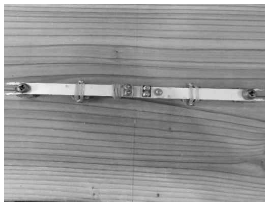
写真-2 歪み測定用固定治具
