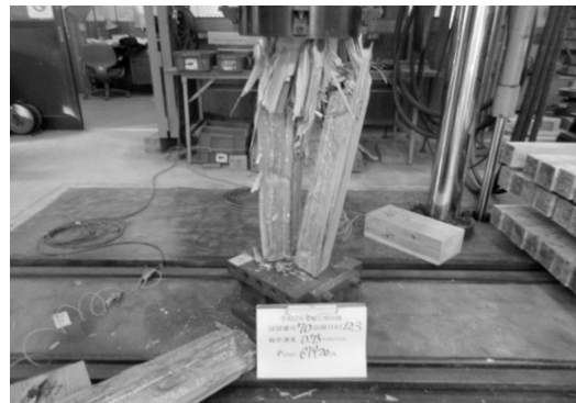
写真-6 割裂して破壊した供試材
