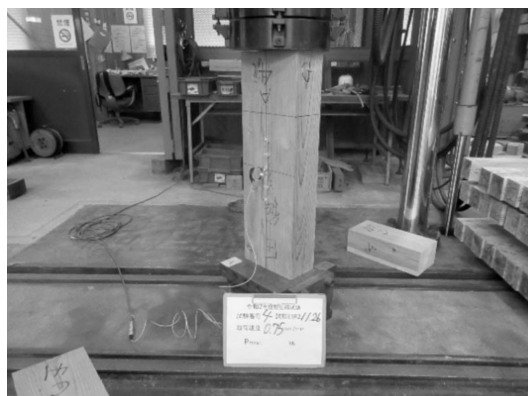
写真-1 縦圧縮試験
