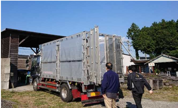
写真1 荷台に枠がついたダンプ車
