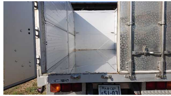
写真2 ステンレス加工された荷台内部
