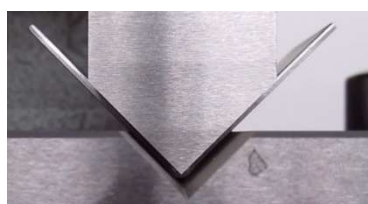
図 18 c. コイニング（押しつぶし）
