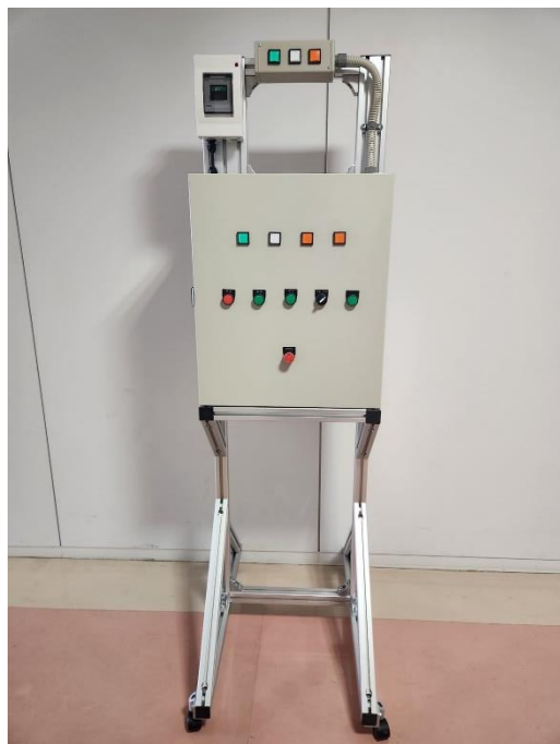
図7 製作した工場電気設備実習装置
