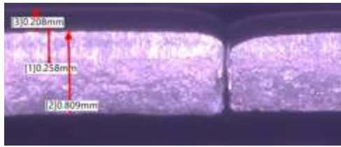
a.左断面 b.右断面 図9 製品のせん断面
