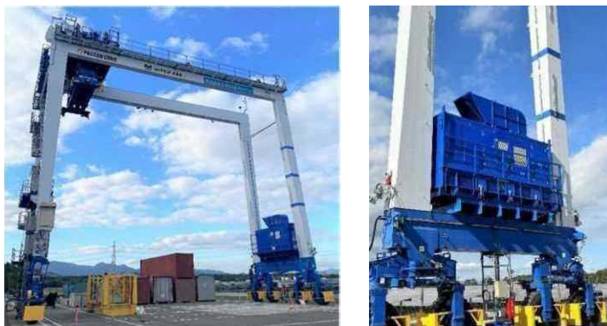
図1 今回実証試験に成功した FC パワーパック搭載の RTGC（左：全体像、右：FC パワーパック搭載部分）
