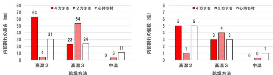
図-6 元口から2,000mmの位置における内部割れの個数と長さ
