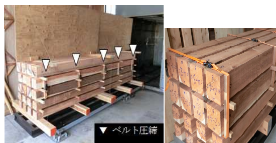
写真-1 試験体の設置とベルト圧縮
