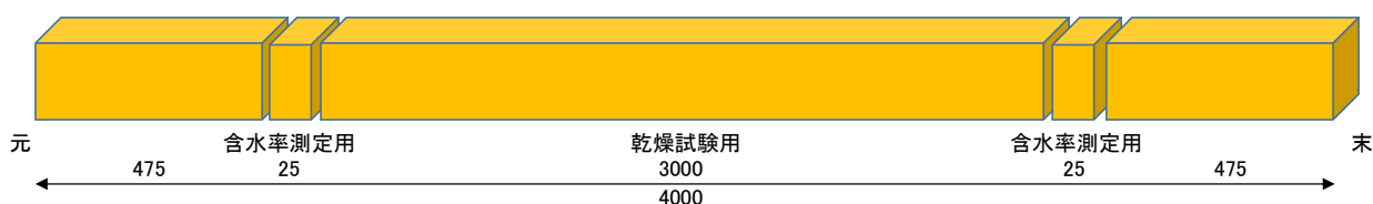
図-4 乾燥試験体の採取方法模式図(数字は長さ(mm)を示す)
