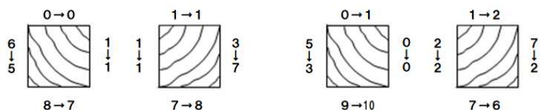
図-12 乾燥前後の矢高の最大値 (単位: mm、乾燥前→乾燥後) 左2つ: ベルト圧縮無し 右2つ: ベルト圧縮有り
