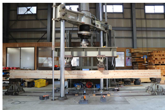
写真-1 曲げ試験の様子
