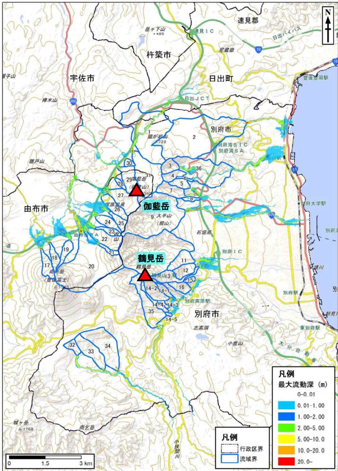
図 4.61 降灰後の土石流のシミュレーション結果 (参考: 100年超過確率規模)
