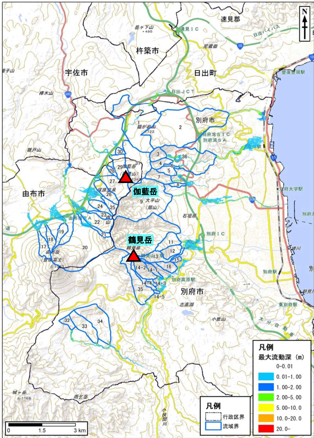
図 4.60 降灰後の土石流のシミュレーション結果 (2年超過確率規模)
