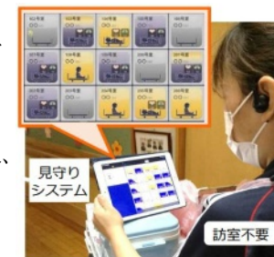
離床センサーと接続した見守りシステム
