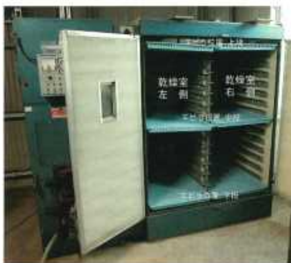
写真I-1 乾燥室内部の説明
