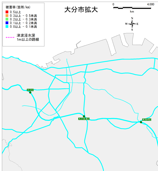
図 8-18 道路被災<周防灘断層群主部>
