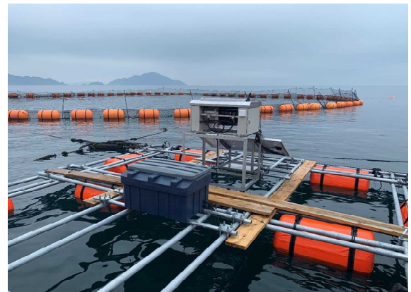
【自動昇降式赤潮観測機（沖合設置型）】
