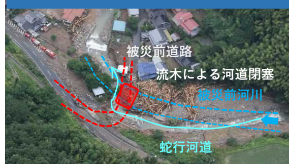
河道閉塞による被害状況
