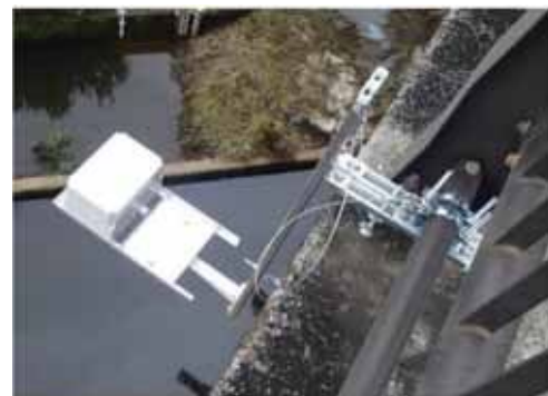
危機管理型水位計 (橋梁に設置するタイプ)
