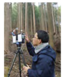
林内を測量する 3Dレーザスキャナ
