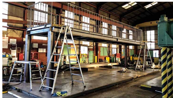
大型物件(歩廊) 大型定盤
