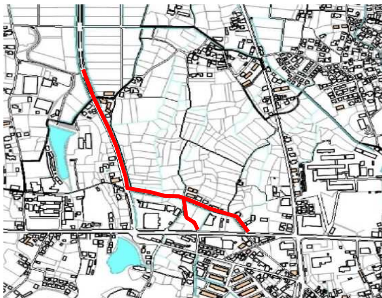
小峰排水区における雨水幹線整備
