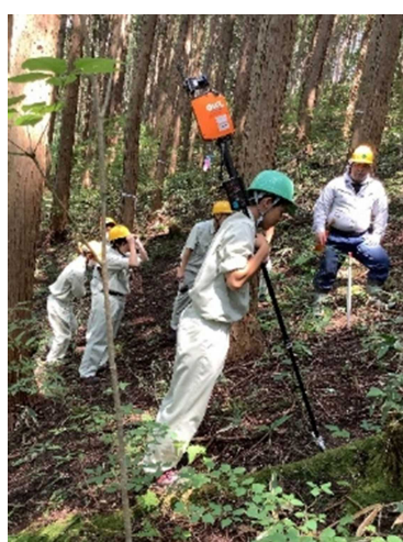
森林3次元計測システム による測量（新見市）
