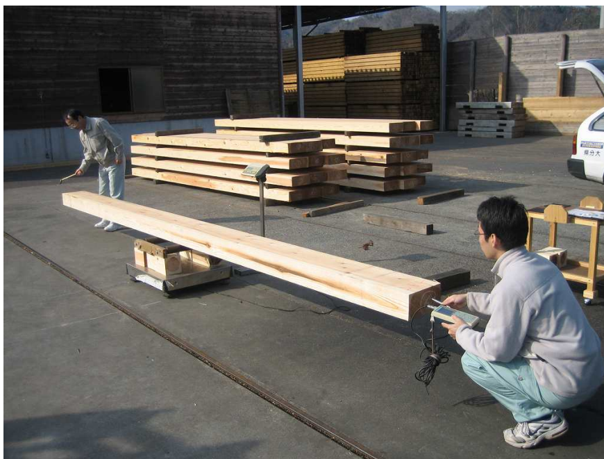
写真6-2 縦振動法による動的ヤング係数の測定様子
