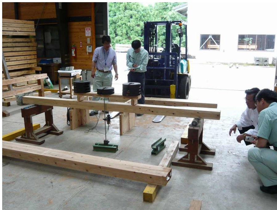
写真6-1 曲げヤング係数の測定の様子
