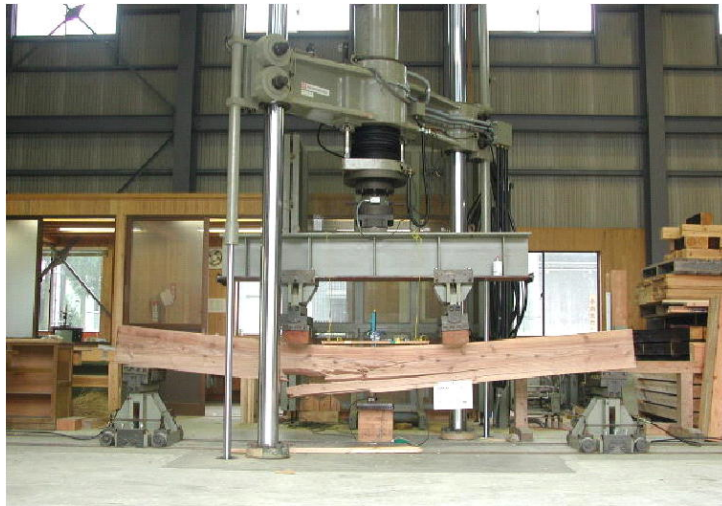
写真6-3 木材の実大強度試験機によるスギ平角材の曲げ強度試験（林業研究部）
