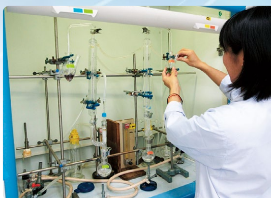
▲ 食品添加物の検査 (通気蒸留装置)
