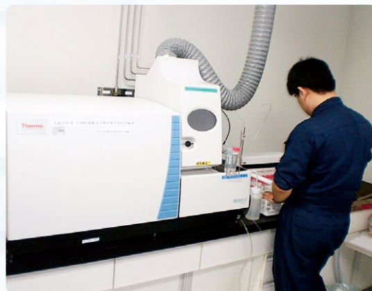
▲ 重金属の測定(ICP質量分析装置)
