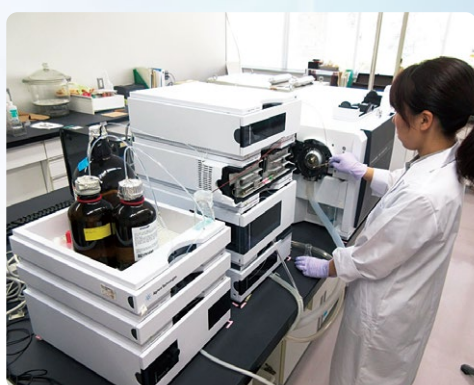
▲ 動物用医薬品の測定 (液体イオンクロマトグラフ質量分析装置)
