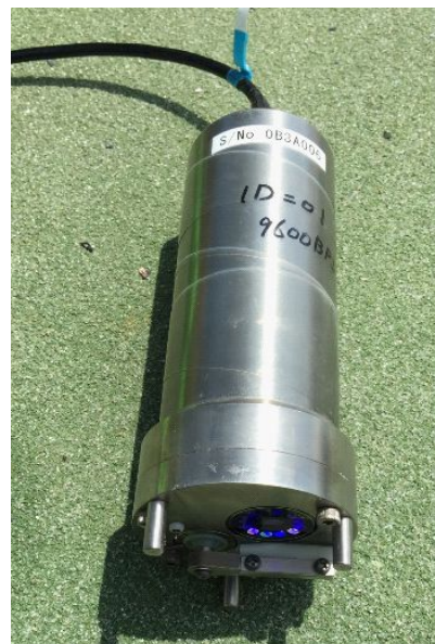
図2 ワイパー付次世代型赤潮観測センサー
