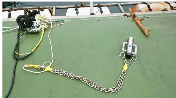
図5 水中カメラの設置
