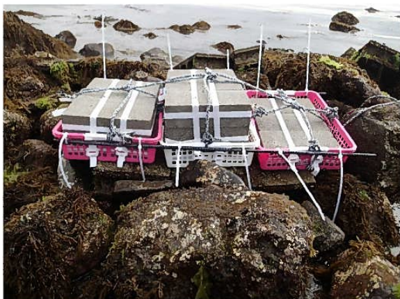
図2 セメントレンガの設置状況（豊後高田市香々地小池）
